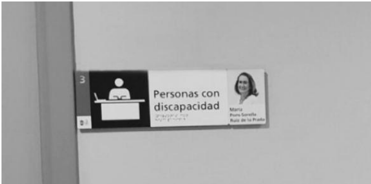
Rótulo identificativo de despacho en un centro de servicios sociales: pictograma, denominación del espacio (texto en alto relieve y braille) y fotografía
